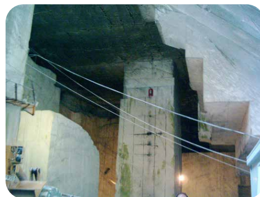
شکل ۳- ستون به جای مانده از یک معدن زیرزمینی مرمریت کارارا ایتالیا
