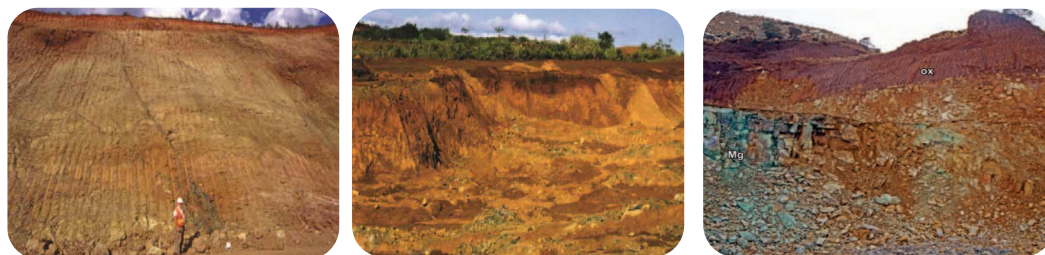
شکل ۲- سنگ معدن اکسید (OX) و سیلیکات منیزیم آبدار (Mg) (راست)، سنگ معدن اکسید روی سنگ بستر (وسط)، سنگ معدن سیلیکات رسی (چپ)
